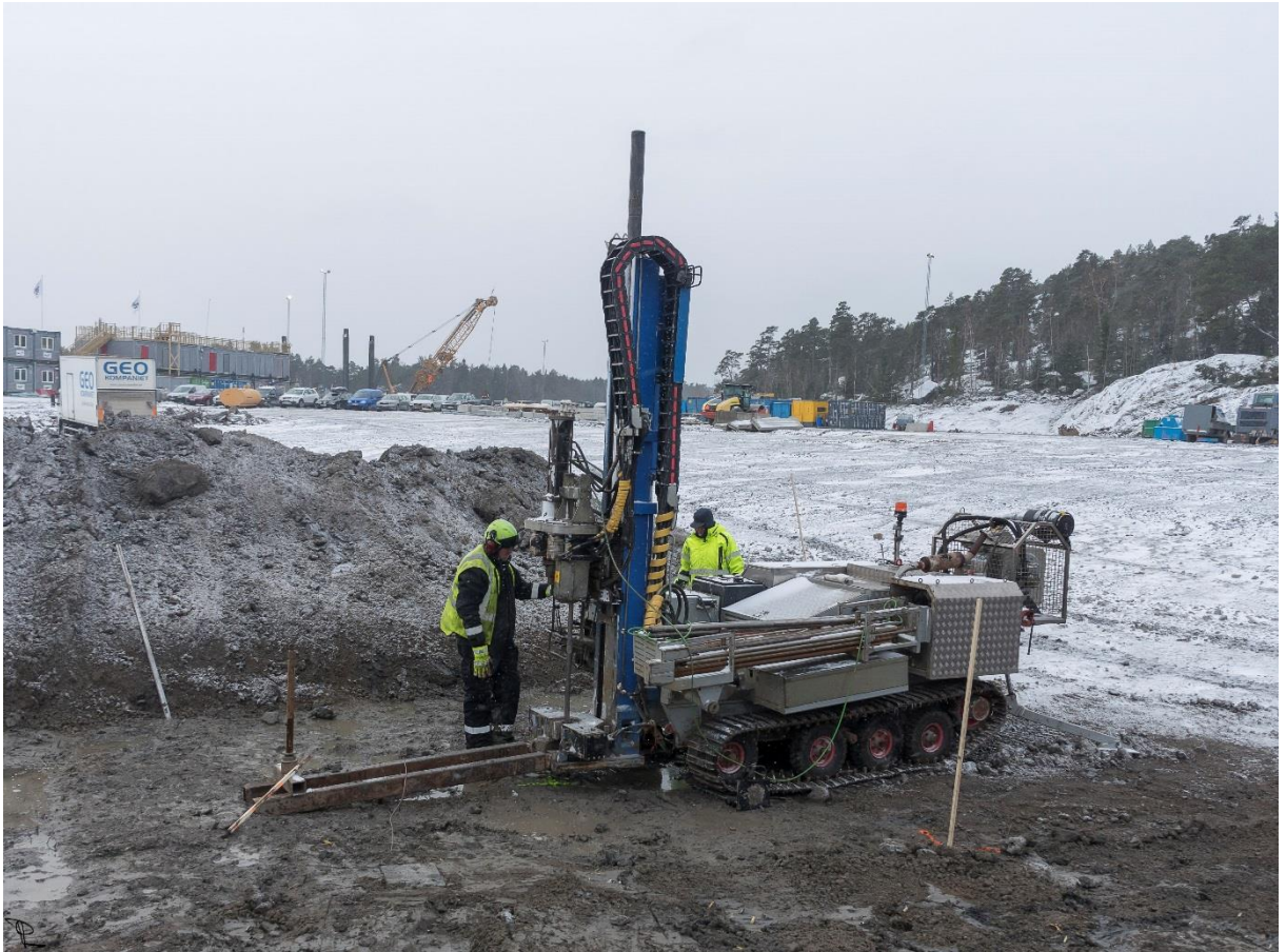
Figur 23. Foto från CPT sondering i Norvik. Foto Per Lindh.
